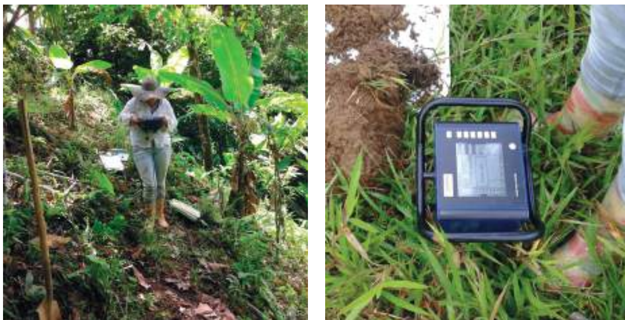
Figura 6. Medición de la compactación del suelo mediante el uso de penetrómetro.
